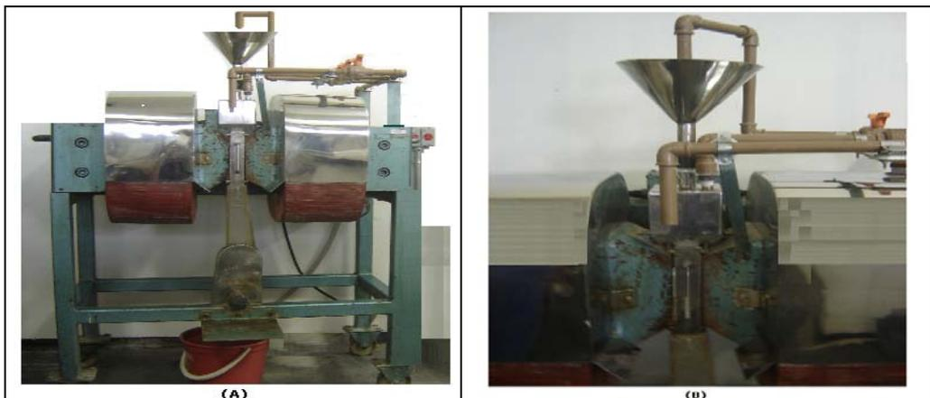
Figura 5 – Separador magnético a úmido de alta intensidade para uso em laboratório (CETEM/MCT).
