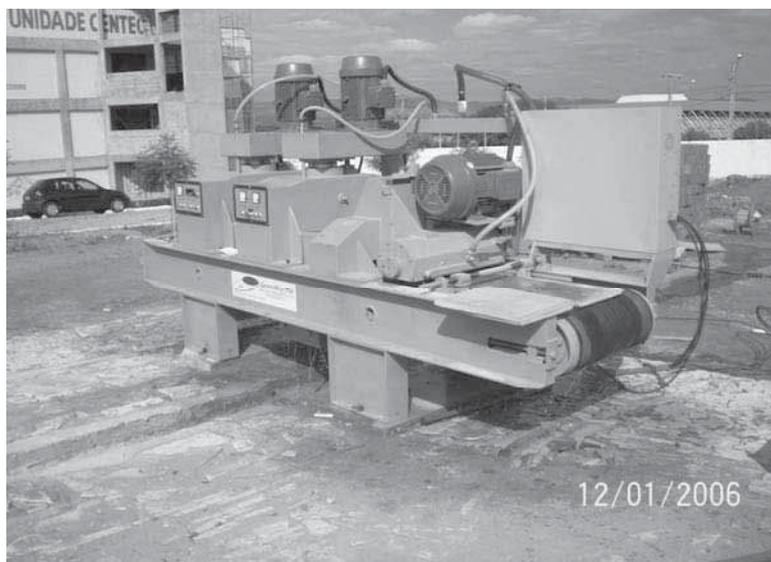
Figura 1: Máquina Calibradora, ajuste de espessura dos ladrilhos
