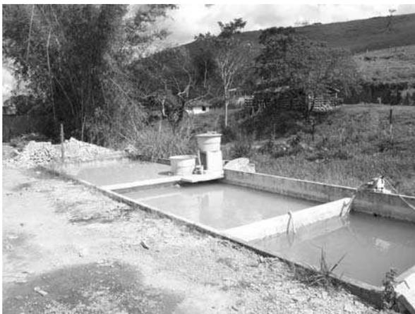
Figura 5 - Tanques de decantação em uma pequena serraria. Foto: CETEM/MCT
