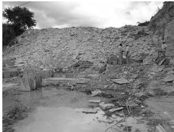
Figura 2 – Disposição inadequada dos rejeitos da lavra
