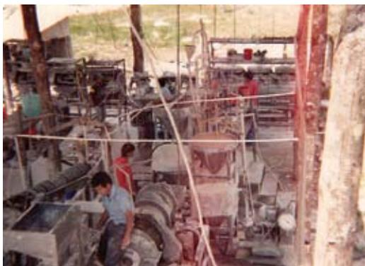
Figura 2 - Usina piloto de flotação de talco, montada e operada pelo CETEM dentro das instalações da empresa Costalco, Ponta Grossa (PR)
