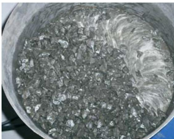
Figura 1 - Operação de recobrimento do minério oxidado com o concentrado de flotação
