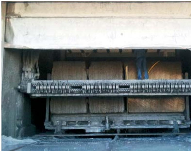
Figura 2 - Detalhamento do corte com multifio
