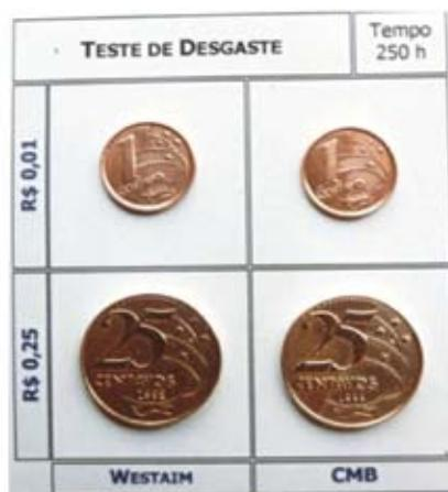
Figura 3 - Fotografia de corpos de prova antes e ao final do ensaio de desgaste
