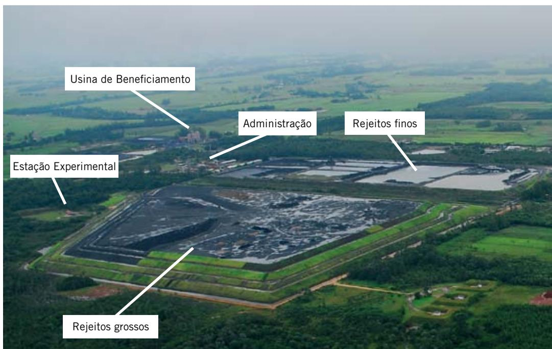
Figura 1 - Vista aérea da região de mineração e da localização da unidade piloto (EEJPB)
