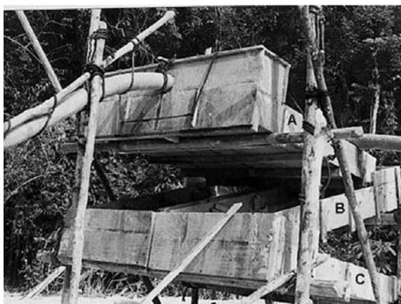
Figura 3 - Calhas concentradoras de ouro usadas no garimpo de Piririma
