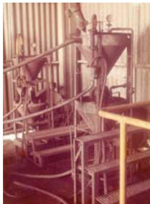
Figura 2 - Unidade composta por hidrociclones, para classificação por tamanho do concentrado "magnético", após sua retirada do separador de tambor
