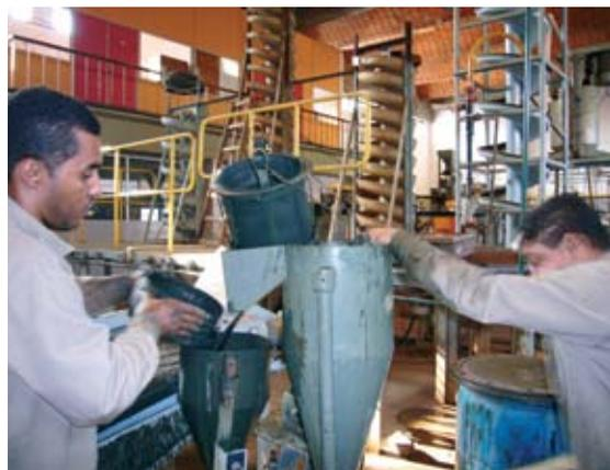
Figura 2 - Operação do cone de meio denso (“sink and float”) na usina piloto do CETEM
