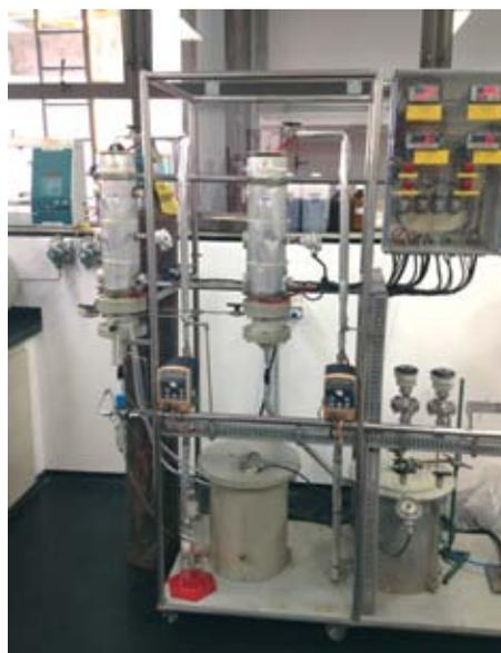
Figura 2 - Unidade semipiloto para biolixiviação do concentrado de flotação
