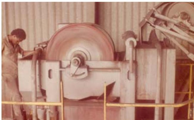
Figura 1 - Separador magnético, via úmida, com baixa intensidade de tambor rotativo, usado pelo CETEM para separar a fração de óxidos com maior teor de magnetita e wustita
