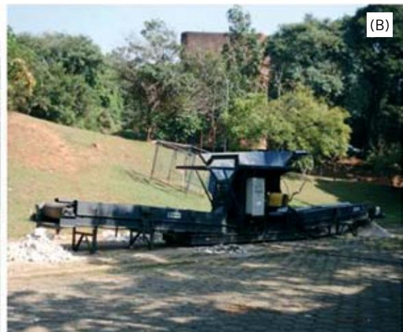
Figura 9 - (A) Caçamba transportadora de RCD; (B) Unidade móvel de processamento de RCD
