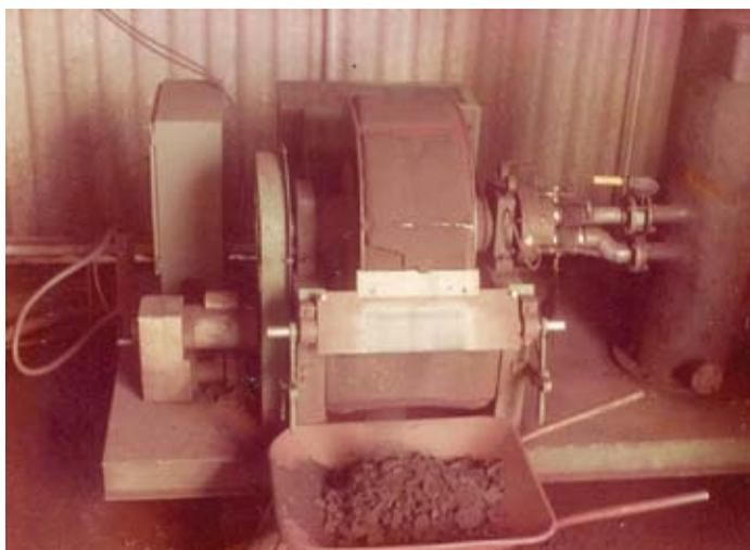
Figura 3 - Produto final (óxidos de ferro de alto teor de magnetita e wustita), sendo filtrado em tambor a vácuo com capacidade de até 400 kg de produto/hora
