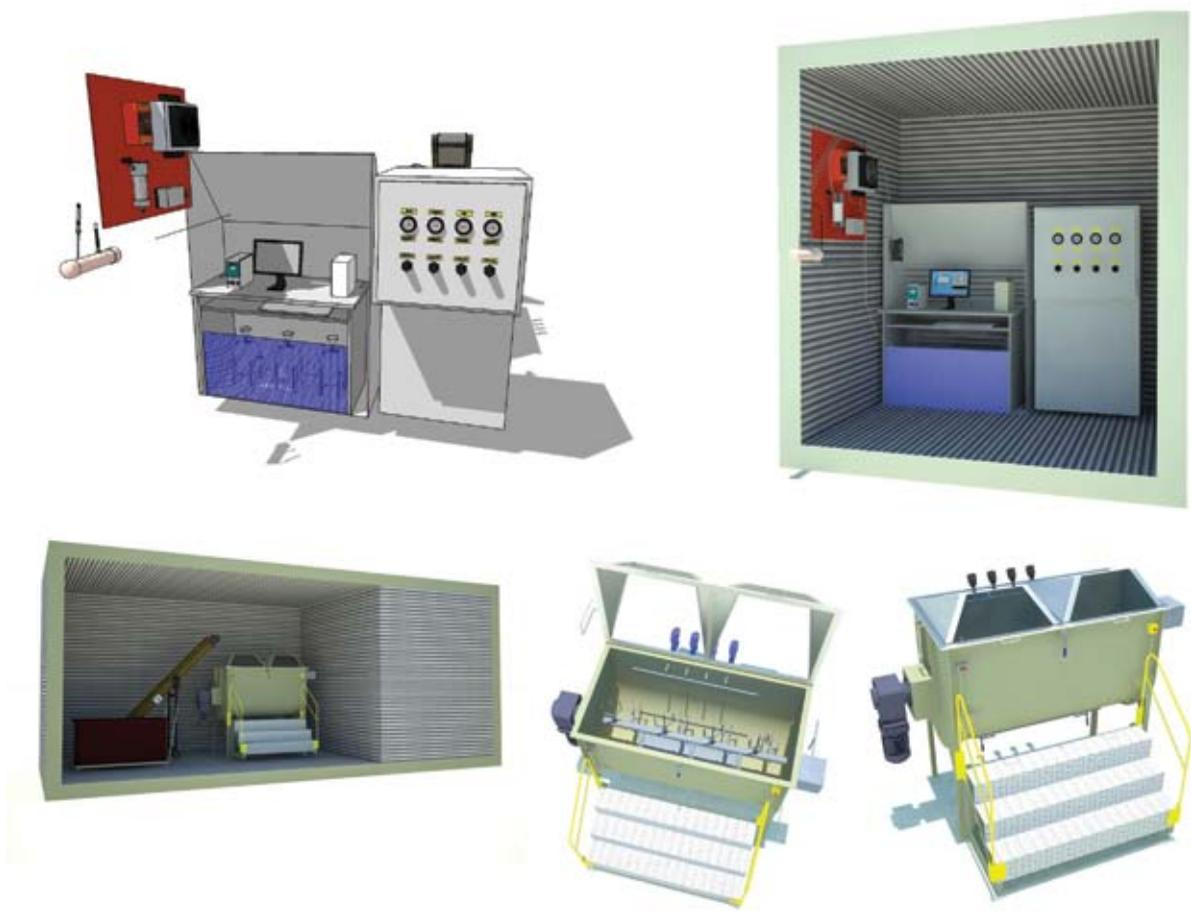
Figura 1 - Unidade de demonstração para biorremediação de solos
