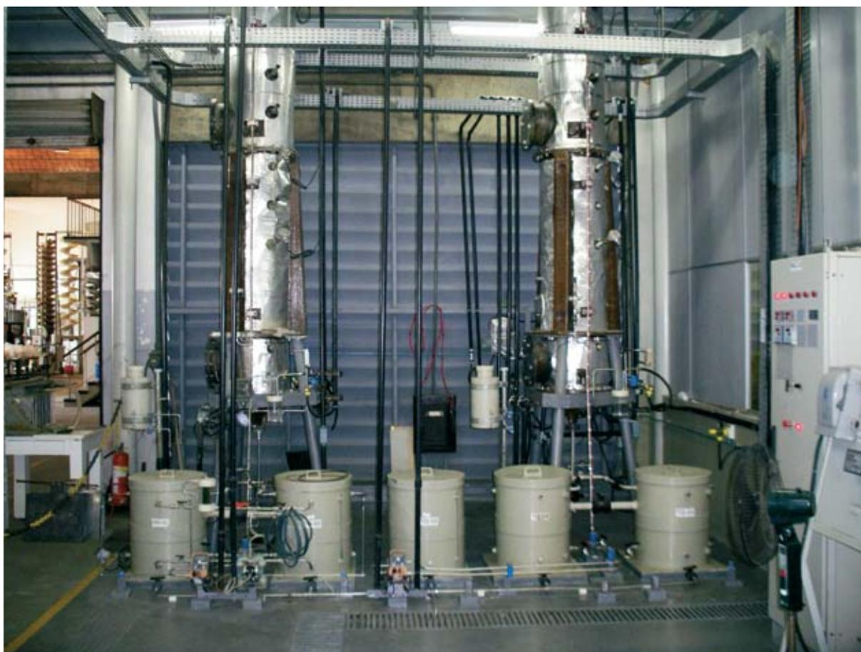
Figura 1 - Unidade piloto utilizada na biolixiviação do minério primário de cobre
