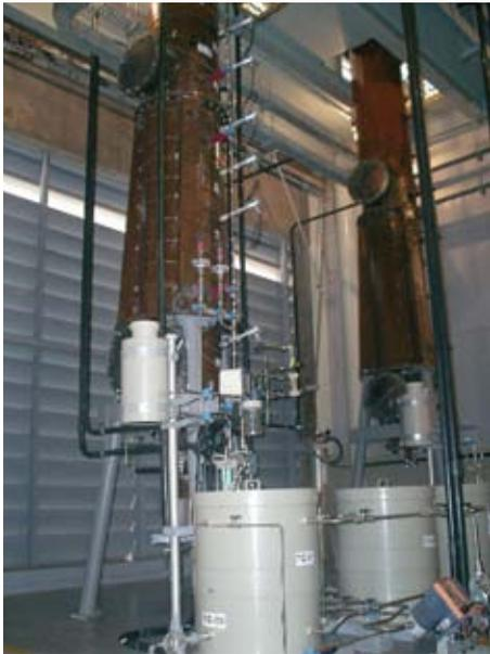
Figura 1 - Unidade piloto do CETEM utilizada na biolixiviação do concentrado piritoso
