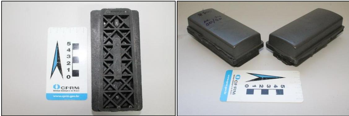
**Figura 4:** Resultados do procedimento 3. Notar o pequeno volume de expansão da peça.
