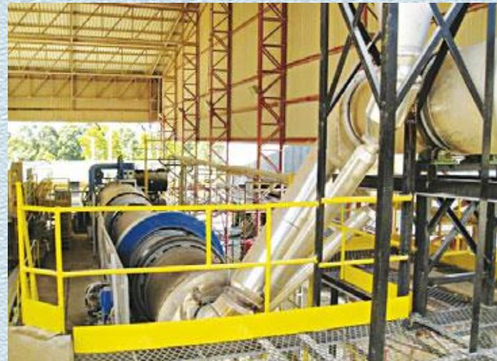
***A água mãe da centrifugação do carbonato é basicamente uma solução de sulfato de sódio que contém um pouco de Lítio a ser recuperado; após resfriamento, o sulfato de sódio decahidratado é precipitado e desidratado em secadores para se obter o coproduto sulfato de sódio anidro.***
