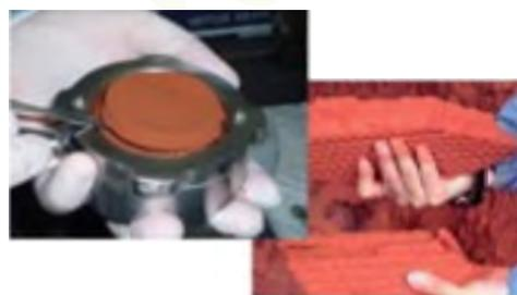
Rejeito filtrado para disposição a seco (*dry stacking*).
