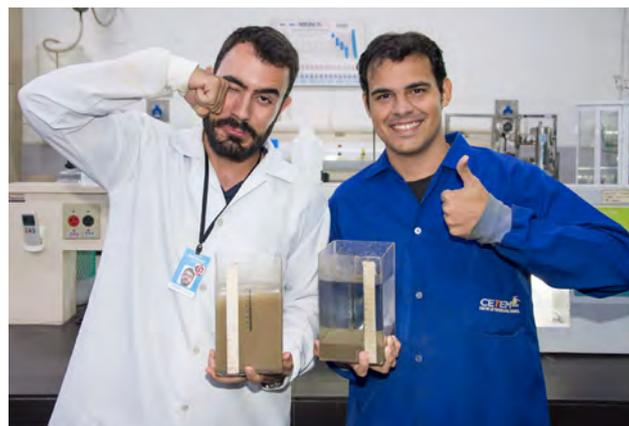
Resultado do uso de polimetos na agregação e desaguamento, resultando em água para reuso industrial.
