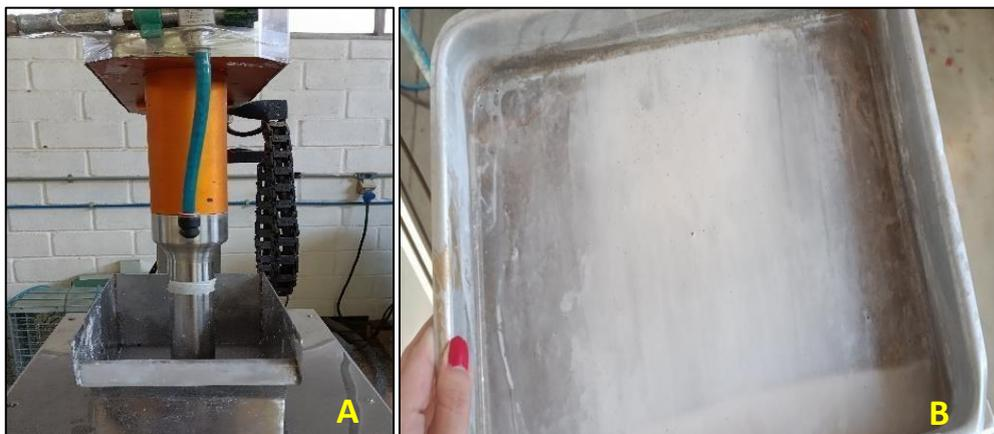
**Figura 2:** Coluna de flotação (A) utilizado na pesquisa e material obtido no processo (B).
