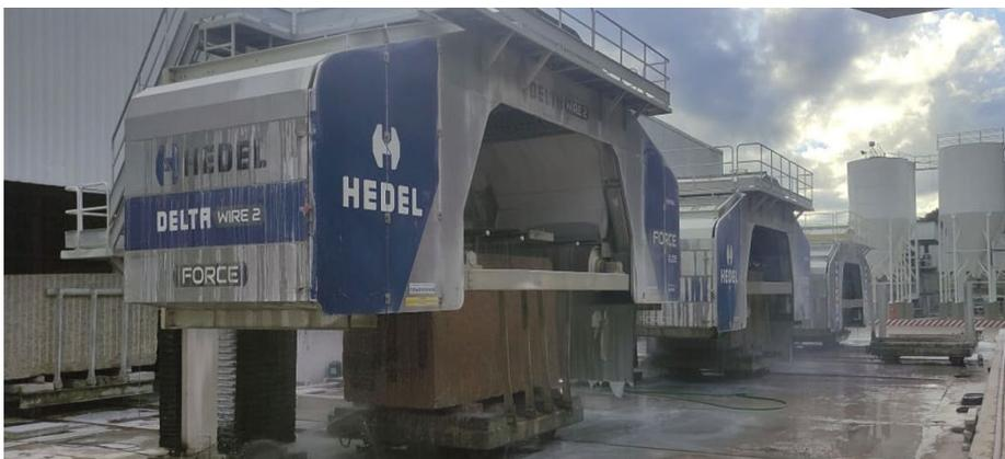
Figura 1. Exemplo de tear multifio, modelo *Delta Wire 2*.
