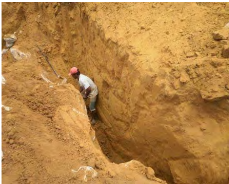
Figura 10: Trincheiras abertas para exploração manual do Mármore Bege Bahia
