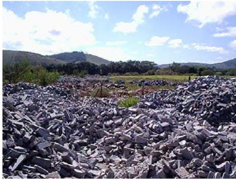
**Figura 1.** Pilha de rejeitos grossos em uma serraria de beneficiamento de gnaisses, Santo Antônio de Pádua, RJ
