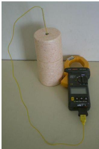
Figura 3 – Calorímetro pseudo-adiabático para acompanhamento da variação do calor de hidratação.
