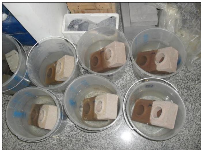
Figura 2 – Imersão dos corpos de prova em água para a determinação dos índices físicos.
