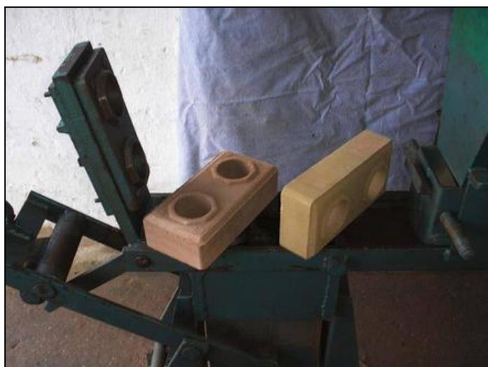
Figura 1 – Prensa utilizada para a confecção dos tijolos de solo-cimento.
