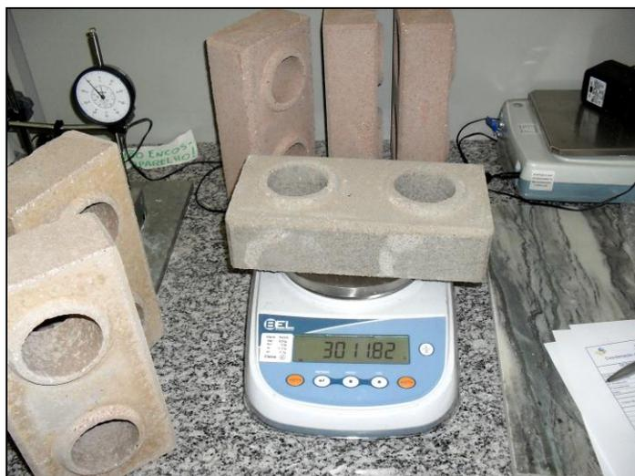
Figura 3 - Pesagem dos corpos de prova submetidos a determinação dos índices físicos.
