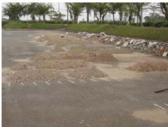
Figura 2- pilhas alongadas da fração menor que 25,4 mm.
