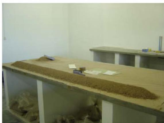
Figura 3- Pilhas alongadas da fração menor que 4,8 mm.
