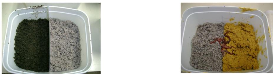
Figura 1 – Teste de comportamento (fuga) com oligoquetas da espécie *Eisenia andrei*.
