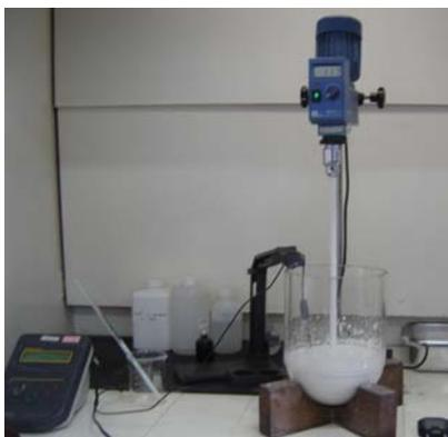
Figura 3 – Reator utilizado nos ensaios de alveamento químico do caulim.
