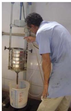
Figura 1- Peneirador vibratório usado na operação de análise granulométrica a úmido.
