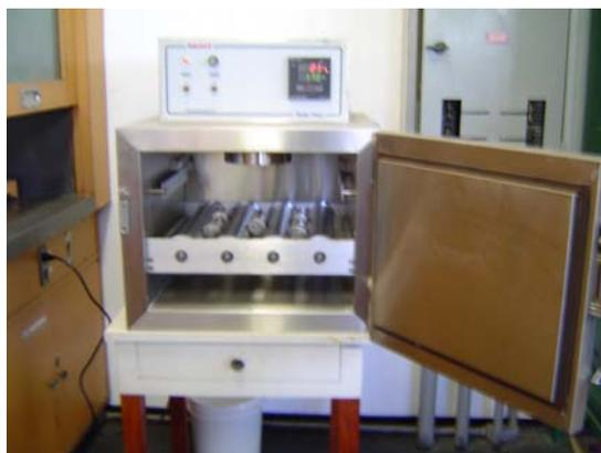
**Figura 2.** Estufa com cilindros rotativos
