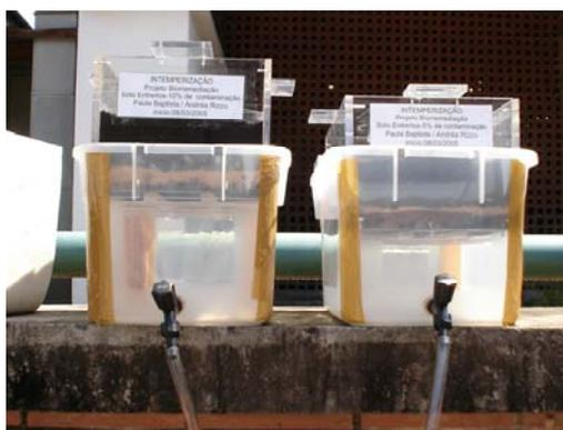
Figura 1. Sistema para acompanhamento do processo de atenuação natural – Microcosmos.
