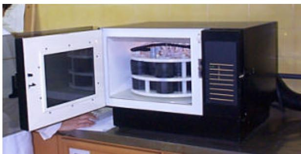
Figura 2 – Forno de microondas Qwave 3000 – Questron Corporation
